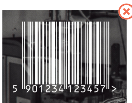
Barcode invertiert auf dunklem Untergrund, nicht lesbar!
